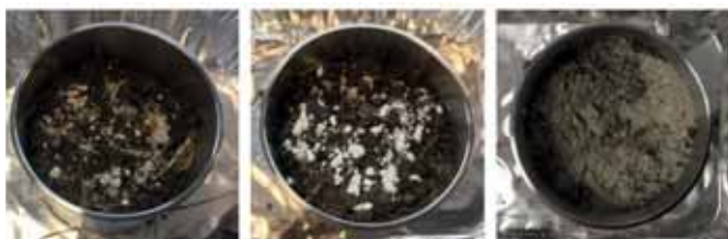
FIGUUR 3: NAAST SURFACTANT IS ER KALK, GIPS EN KLEI TOEGEVOEGD AAN DE RINGEN MET VEENBODEN IN HET LAB EXPERIMENT ALS MAATREGEL OM WATERAFSTOTENDHEID TE VERMINDEREN. DE TOEGEPASTE HOEVEELHEDEN KWAMEN OVEREEN MET 1 TON PER HA VOOR KALK EN GIPS, EN 10 TON PER HA (DROOGGEWICHT) VOOR KLEI.
