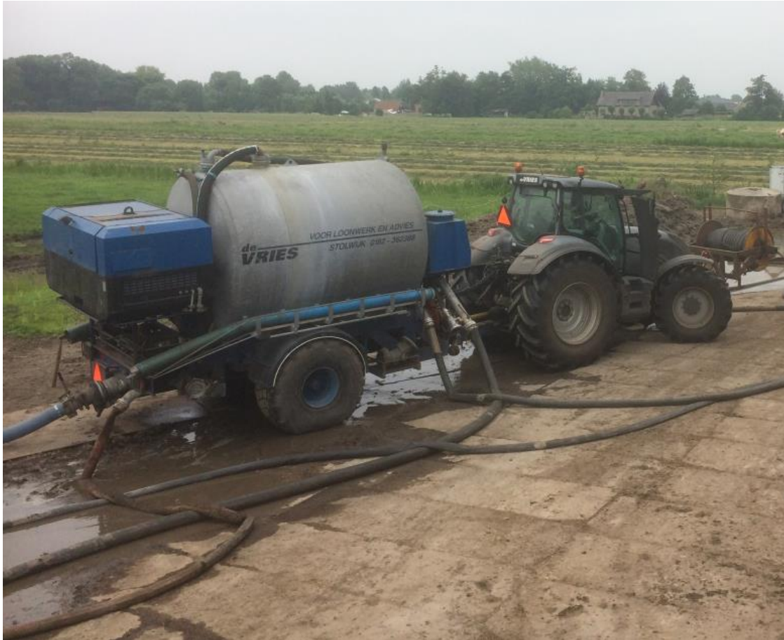
Afbeelding 11. Pompsysteem gebruikt voor het verpompen van kleimelk. Normaal wordt deze ingezet voor drijfmest waarbij de pomp een capaciteit heeft van 140 m 3 per uur bij een slanglengte van 200 m. Eventueel kunnen suspensies tot bijna 2 kilometer verpompt worden, al dan niet met tussenkomst van een tweede pomp.
