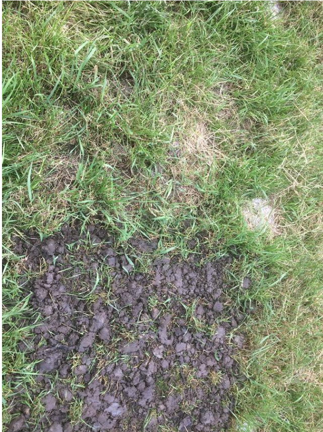
Afbeelding 17. Twee proefplotjes van 1 x 1 m op 26 juni 2019, beide met een dosering van 1 cm droge stof kleibagger. Boven aangebracht op 17 januari en onder aangebracht op 26 juni 2019.
