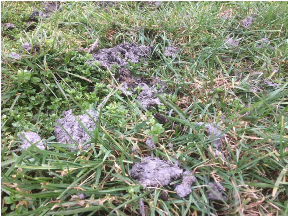
Afbeelding 4. Kleibagger verspreid met een meststrooier, circa drie weken na verspreiding. De kleibagger was duidelijk aan het drogen en werd korreliger. Foto 28 februari 2019.
