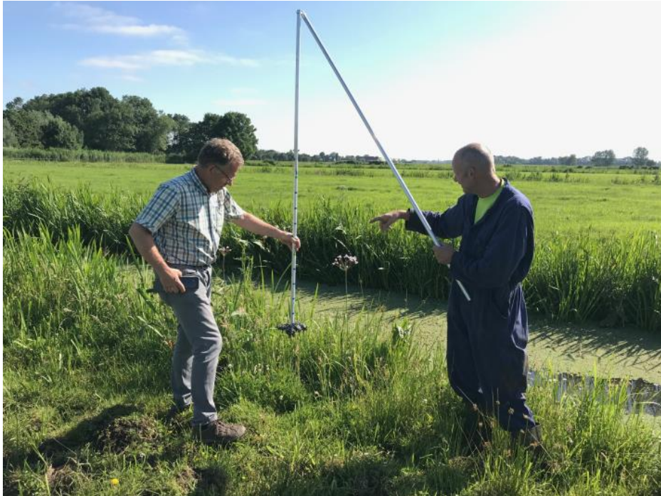
Afbeelding 6. Na enkele weken was de uitgezakte kleibagger met een peilstok terug te vinden tot nagenoeg het einde van de sloot (ca. 170 m verderop).
