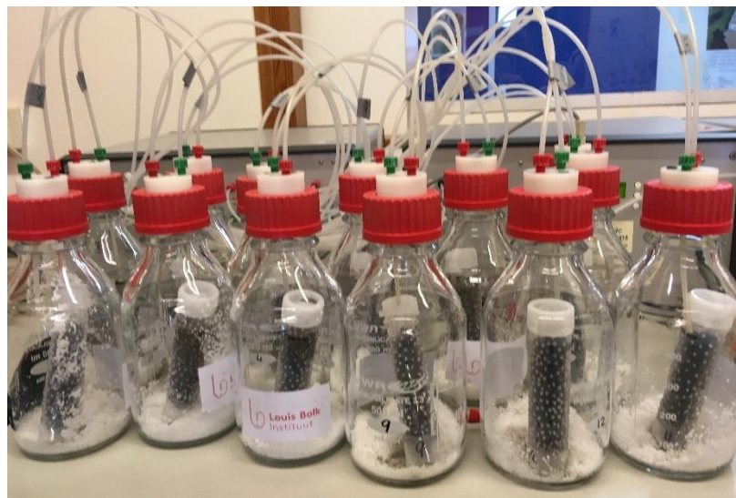
Figuur 3. Meetopstelling met veenkolommen in een laag perliet
