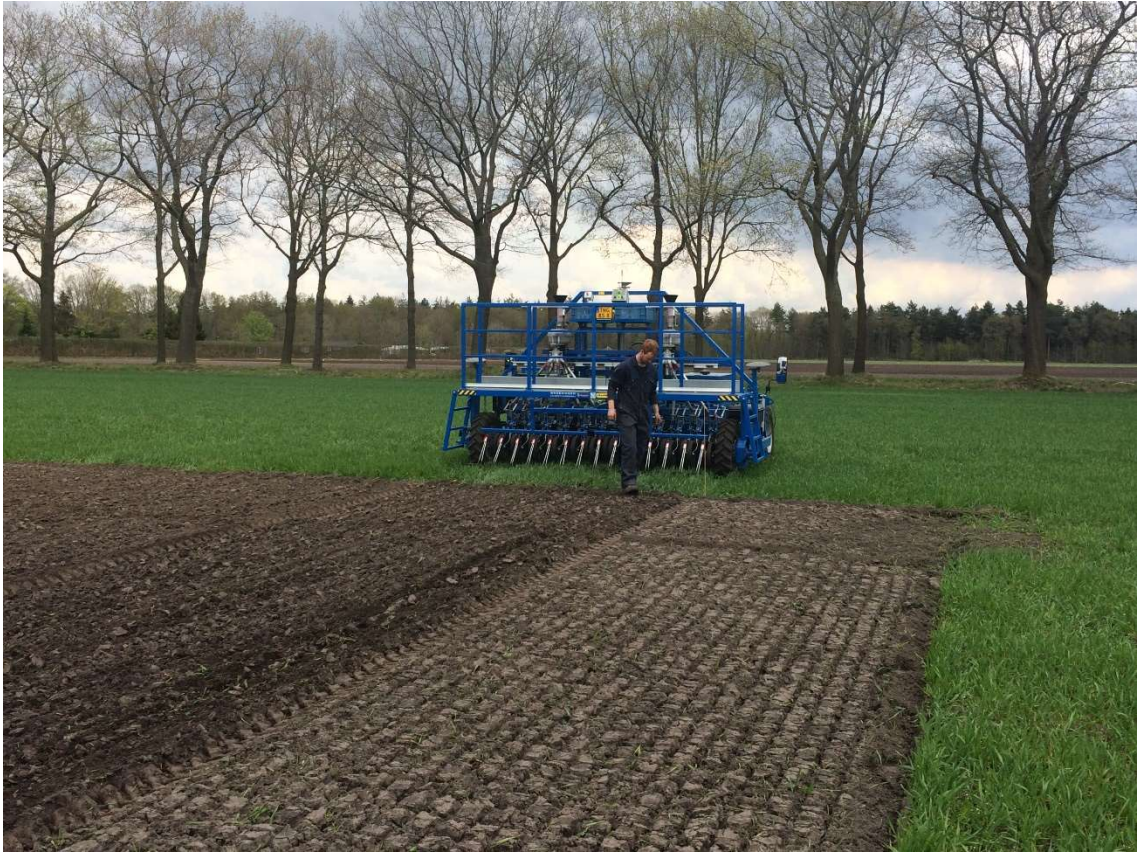
Figuur 3-1: Proefveldzaamachine met werkbreedte van 3 meter.
