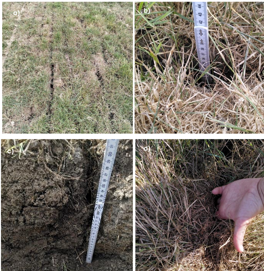
Figuur 8. Foto's van scheuren in grasland waarin is gesneden met de zodenbemester a) Scheuren volgen de sleuven van het zodenbemesten (KV); b) De duimstok meet ongeveer 38 cm scheurdiepte (KV); c) scheuren lopen door tot in het schalterveen (KV, 6/9/22). Scheuren zijn moeilijk terug te vinden onder het hoge gras (V1, 6/9/22); d) Ondiepe scheur.
