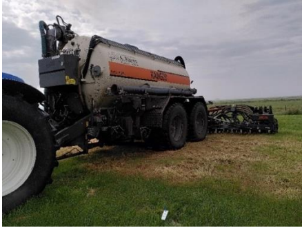
Figuur 2. a) Zodenbemester waarmee gesneden en bemest werd. b) Zojuist bemeste graszode.
