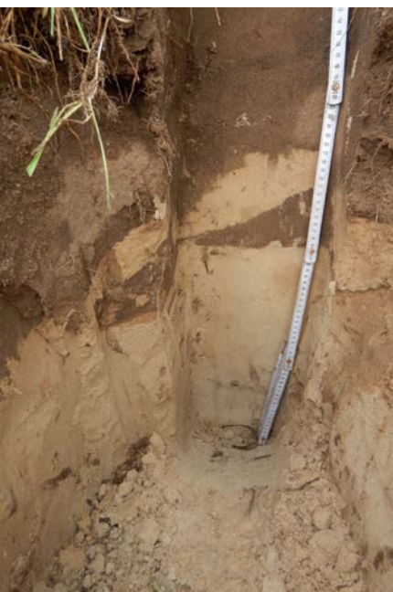
Foto 1. Spitten zonder mengplaten geeft geen goede menging in de onderlaag
