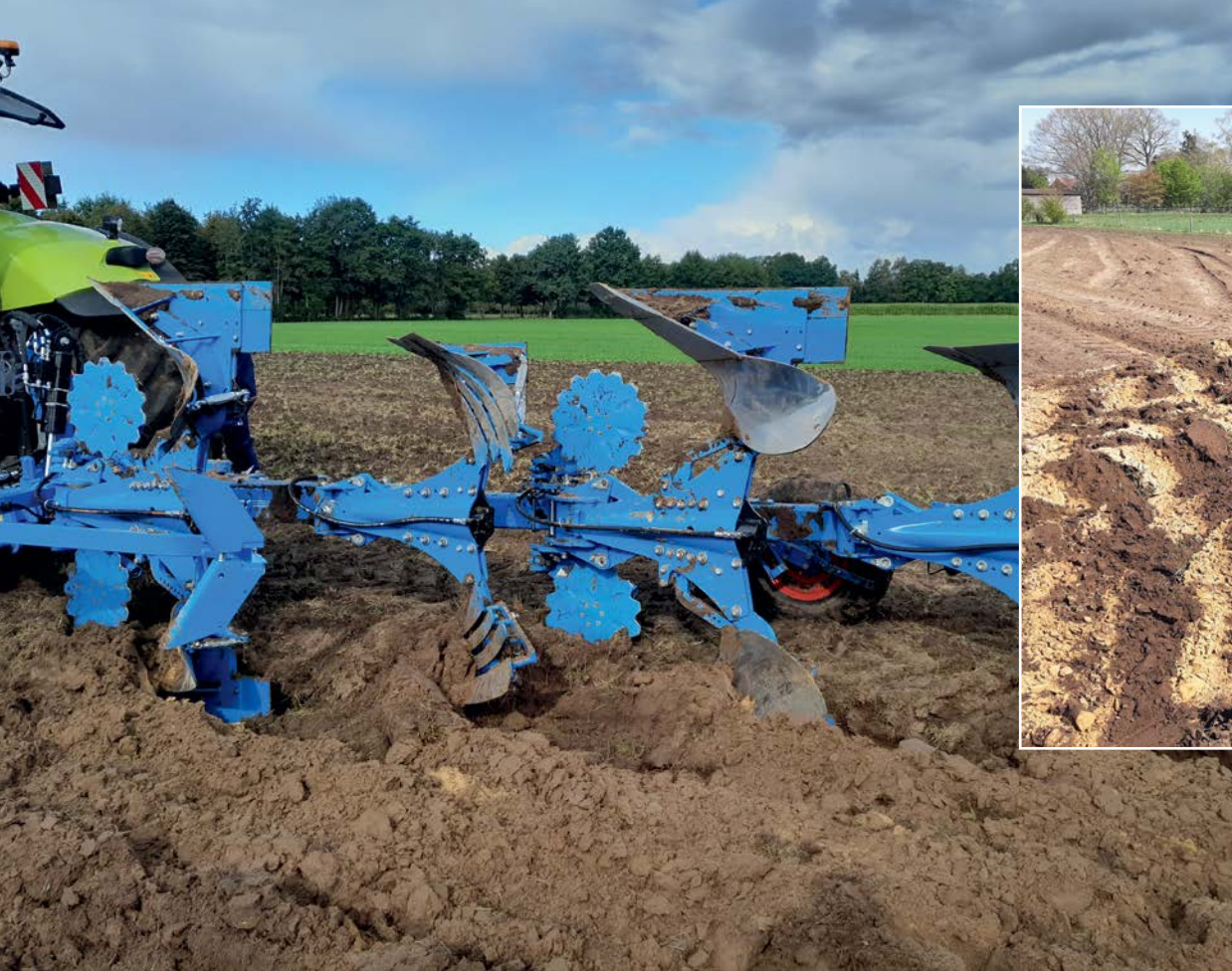
ZALF-ploeg van Lemken met risters met ongelijke afmetingen
