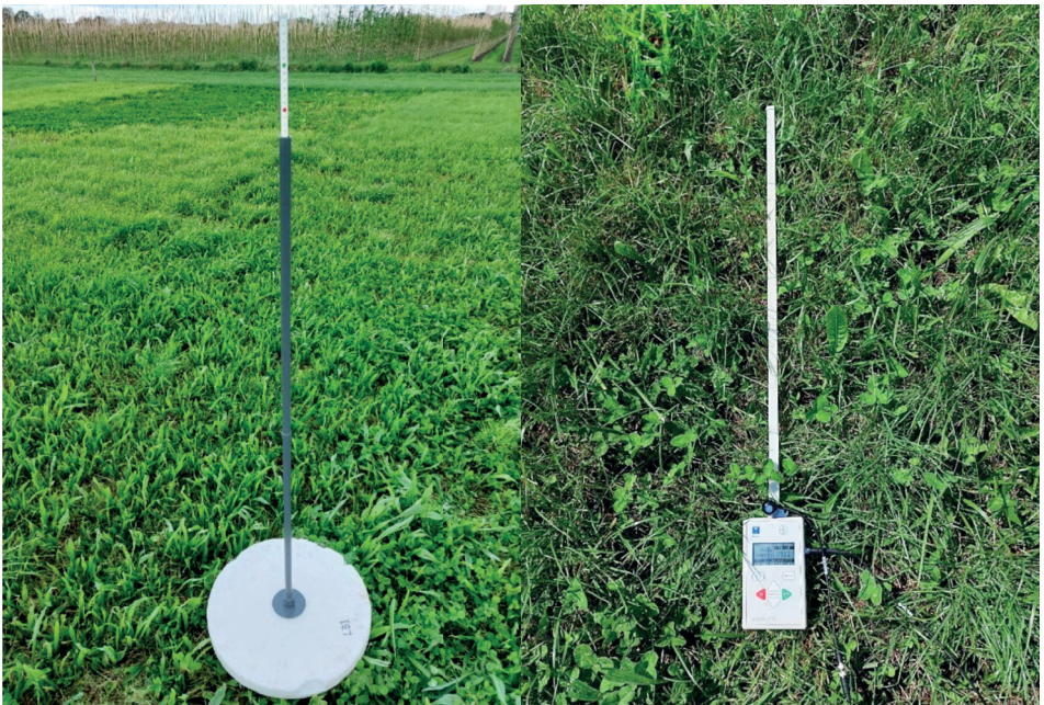
Afbeelding 2 Vegetatiehoogtemetingen met behulp van een piepschuimblok (links) en bladopvlakmetingen met behulp van lichtintensiteitsmetingen (rechts)
