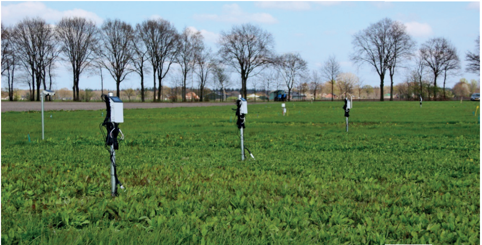
Afbeelding 1 Veldlocatie De Moer met dataloggers, bodemvochtsensoren en tensiometers. Op de voorgrond het gewas cichorei
