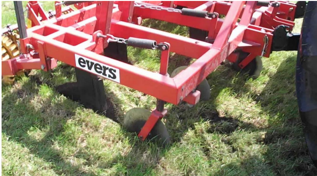
Figuur 3.5. De graslandwoeler tilt de grasmat op en maakt zo de bodem los. Foto uit: De Boer et al., 2016.
