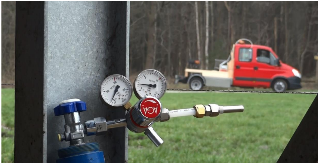
Figuur 5: Meetwagen rijdend benedenwinds van de kwatrijstal en op de voorgrond de lachgas tracer.
