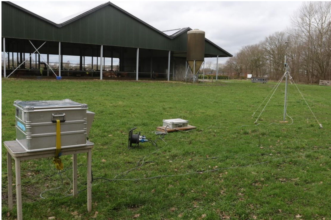
Figuur 6: De mini-DOAS en de windmeter aan de oostzijde van de kwatrijnstal
