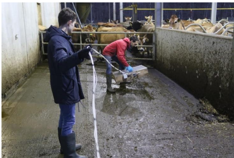
Figuur 4: Boxmetingen op de stalvloer, met de twee QCL's in de meetwagen met aanzuiging vanuit de box
