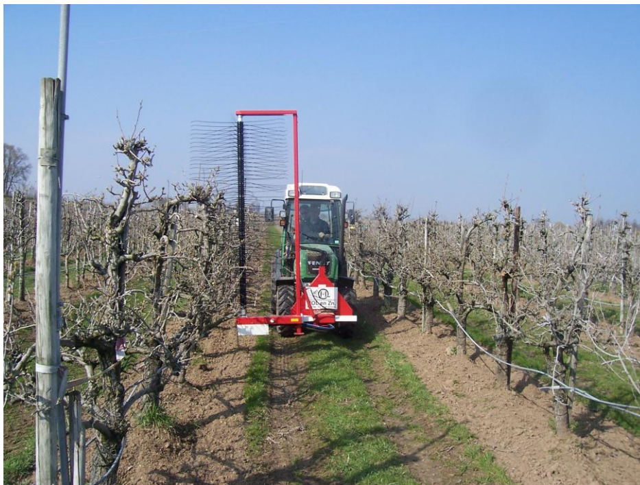
Figuur 2. De Darwin dunmachine aan het werk bij Harmen Peters, met bestuurder Adolf Betz: vlak langs de bomen rijden met 8 km/uur en hoge rotaties per minuut. De boomgaard had bredere rijpaden.
