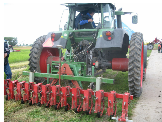
Met een spoorbreedte van 3.15 m en in combinatie met RTP-GPS kan deze trekker tot op 1-3 cm nauwkeurig steeds op vaste rijpaden werken. De bodemstructuur wordt hiermee gespaard.
