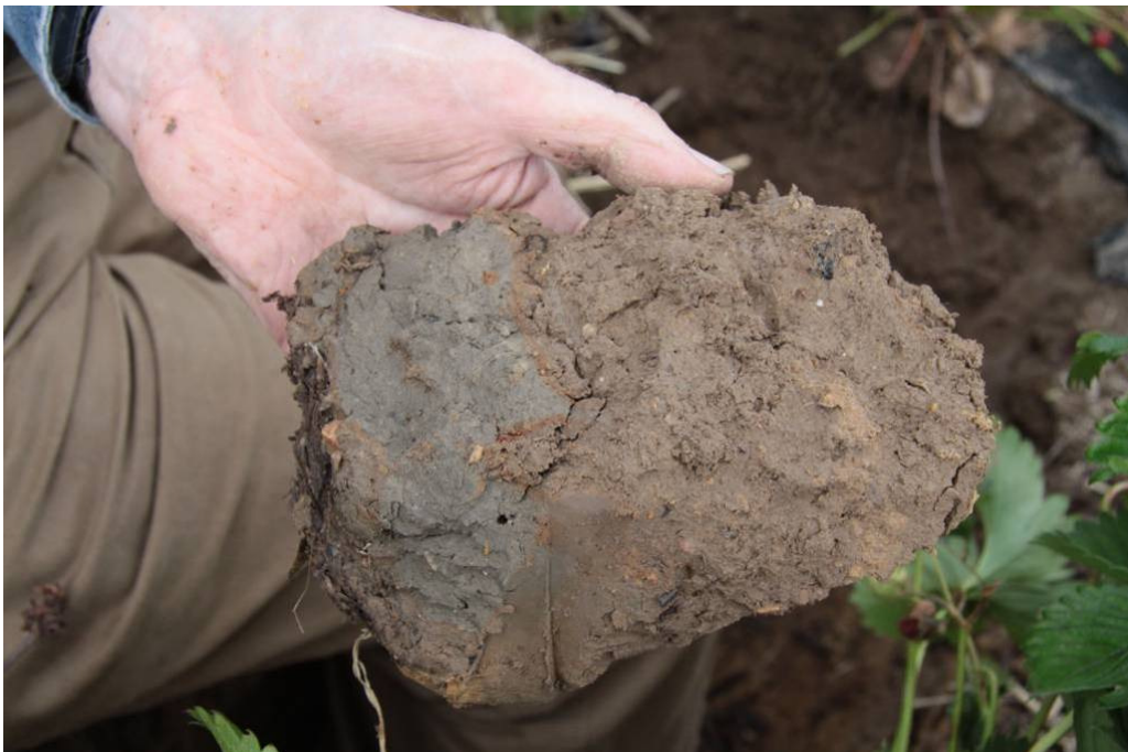
Figuur 4.7: Beoordeling van fysische bodemstructuur in het veld maakt ook bodemlevenactiviteit zichtbaar. Door verdichting ontstaan anaerobe omstandigheden en zorgen bacteriën voor blauwverkleuring.
