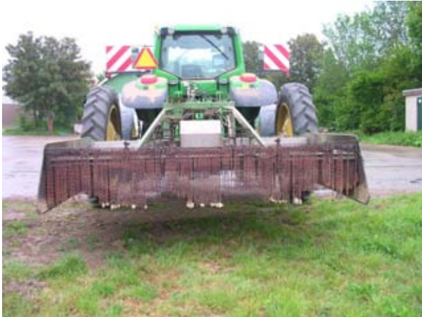
Figuur 5-14: Trekker met onkruidbrander op 3.20 meter wielafstand
