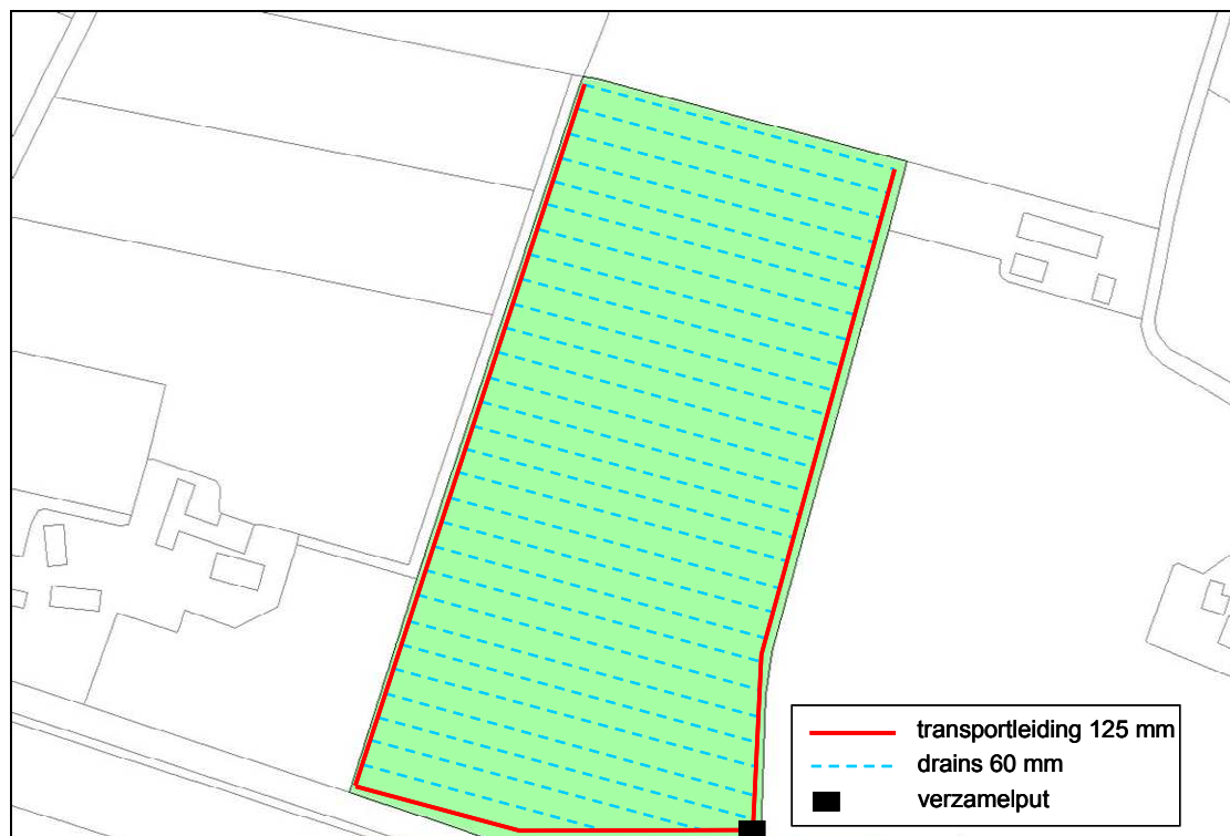
Figuur 6: Ontwerp voor infiltratiesysteem bedrijf B
