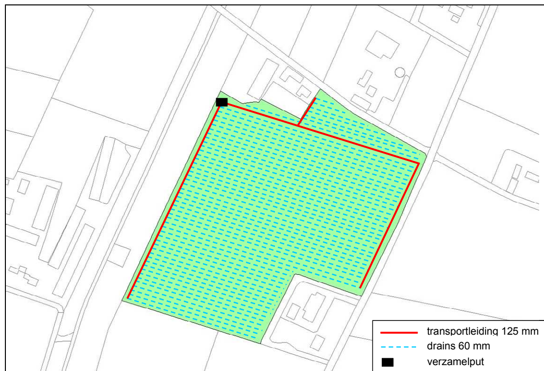
Figuur 5: Peilgestuurd drainage systeem voor bedrijf A
