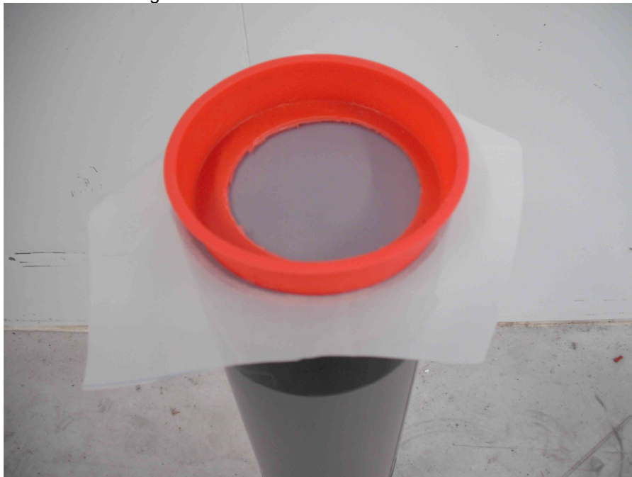
Foto 1 Filterdoek met daar bovenop de flexibele einddop, juist voor het inbrengen en vastklemmen in de buis
