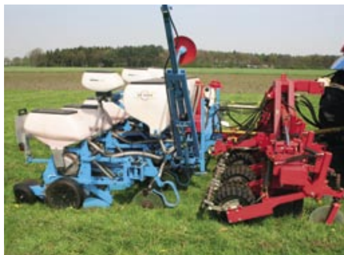
De Hunter van Evers-Agro met een schijfkouter en woelpoot gevolgd door een Monosem zaaimachine.
