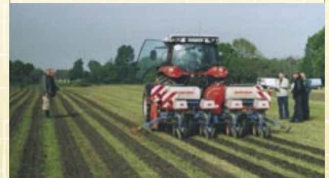
Foto: Zwitserse machine met woelpoot en freeselement
